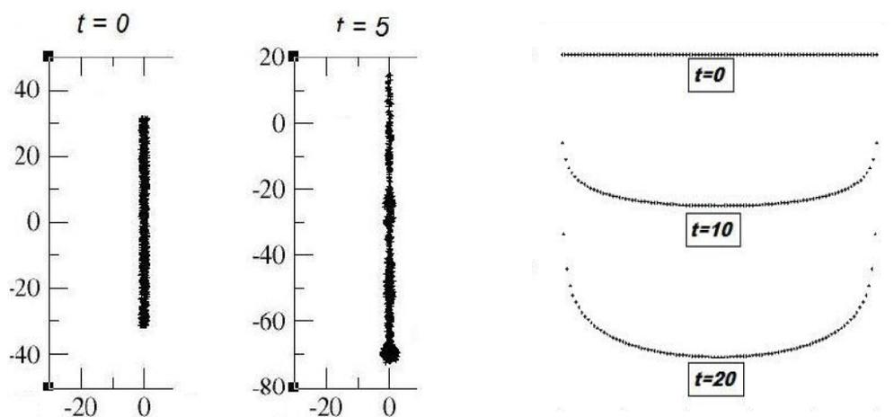
Simulation numérique d'un jet granulaire (gauche) ou de la sédimentation d'une ligne de grains (droite) .
