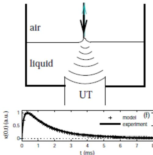
(haut) Montage permettant de mesurer les propriétés d'un liquide sans contact. UT : Générateur d'impulsions. L'interface se déforme et on peut suivre la dynamique de sa courbure  $\kappa(0,t)$  (bas) par des méthodes optiques. Le temps caractéristique déduit peut fournir la viscosité ou la tension interfaciale. Source : LOMA
