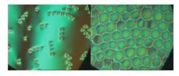
Exemples d'auto-organisation d'inclusions dans une membrane de CL (images de microscopie optique en lumière polarisée ; largeur ~ 200µm)
