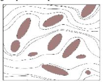
Lignes de courants d'une simulation d'écoulement de fluide visqueux autour de particules solides immobiles.
