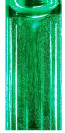
Courant de convection observé par PIV dans une cellule cylindrique.
