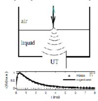
(haut) Montage permettant de mesurer les propriétés d'un liquide sans contact. UT : Générateur d'impulsions. L'interface se déforme et on peut suivre la dynamique de sa courbure  $\kappa(0,t)$  (bas) par des méthodes optiques. Le temps caractéristique déduit peut fournir la viscosité ou la tension interfaciale. Source : LOMA
