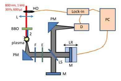
Fig. 1 : schéma expérimental de génération THz dans un plasma par filamentation laser à deux couleurs.
