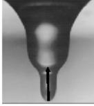
Formes en tétines résultant de la propagation d'une onde optique (gauche) ou acoustique (droite) dans des systèmes d'interfaces liquide-liquide. La flèche représente le sens de propagation de l'onde. Source : LOMA
