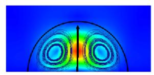
Simulation de l'hydrodynamique induite par la force de diffusion d'un laser sur une goutte de liquide posée. Sont representés le champ de vitesse et de lignes de courants induits. Source : LOMA
